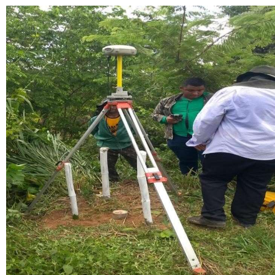
Implantação de Marcos de apoio Geodésico e levantamento Topobatimétrico
